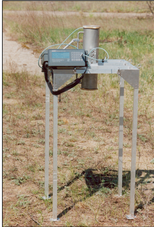
Abbildung 1-7: Bodenmessung (Ortsdosis) mit dem Messsystem MAB500
