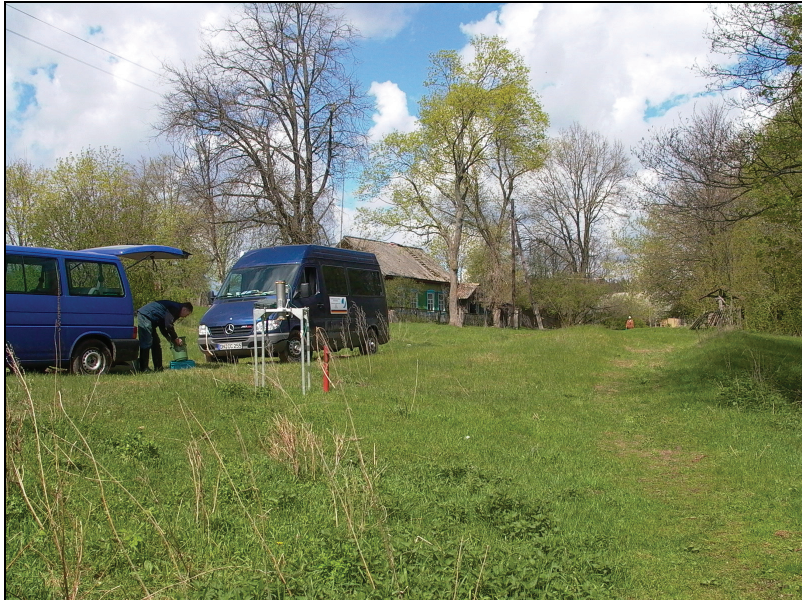
Foto 19: Vorbereitung der Ortsdosis-Messungen und Bodenprobennahme in Volincy (2005)
