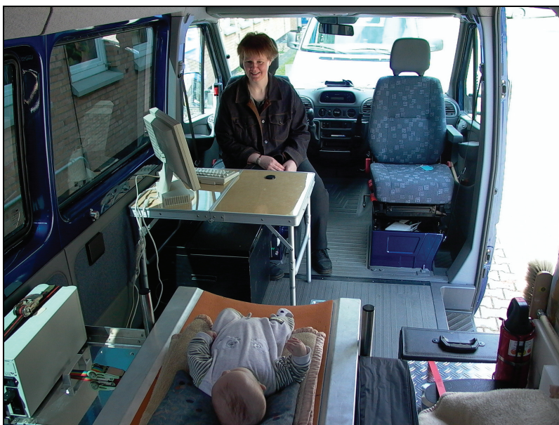
Foto 2: Messfahrzeug des Forschungszentrums Jülich mit Ganzkörperzähler und Auswerteeinheit
